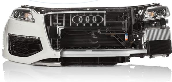
*Le module bloc-avant est un ensemble complexe à l'avant du véhicule, qui, à partir d'une face avant technique, intègre la poutre d'absorption de choc, les systèmes d'éclairage et de refroidissement moteur, les volets actifs de calandre ainsi que les radars et capteurs d'aide à la conduite.*
