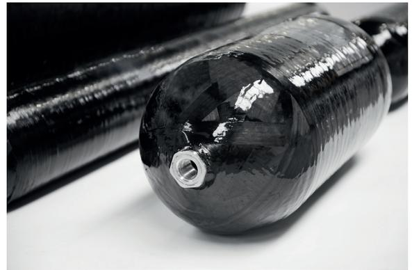
Les réservoirs hydrogène haute pression ont pour mission de stocker l'énergie nécessaire au mouvement électrique du véhicule. Le réservoir à hydrogène de type IV est composé à 100 % de matières plastiques et entouré de fibres carbone pour assurer la résistance du réservoir.
