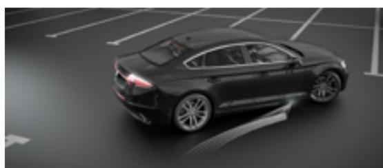
**Cela en fait le premier module de projection au monde basé sur le système de microlentilles pour l'éclairage non statique du sol à côté d'un véhicule.**
