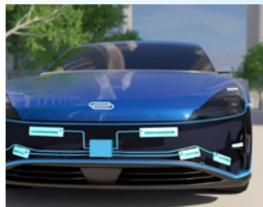
Le **radar imageur 4D** : capable de percevoir en temps réel l'environnement en 3D quelles que soient les conditions météo (page 6).
