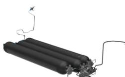
Le système de stockage pour véhicules utilitaires est composé de 3 ou 4 réservoirs hydrogène haute pression de 47 litres, embarquant respectivement environ 2 kg d'hydrogène. Positionnés dans le plancher du véhicule, ils embarquent ainsi entre 6 et 8 kg d'hydrogène au total, assurant ainsi une autonomie de près de 500 km.
