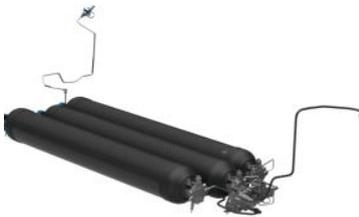
Pour les **véhicules utilitaires légers**, OPmobility propose une solution de stockage d'hydrogène flexible composé de **trois ou quatre réservoirs haute pression de type IV (700 bar) de 47L chacun**, permettant de **stocker de 5,6kg à 7,6kg d'hydrogène pour une autonomie de plus de 500 kilomètres**. Ces réservoirs sont placés dans le châssis, ce qui permet d'optimiser l'espace disponible dans le véhicule.
