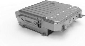
Pour la première fois au Japon, OPmobility présente une **solution complète et intégrée** pour les **véhicules électriques à pile à combustible (FCEV)**. Cette solution s'appuie sur un **système de stockage d'hydrogène haute pression intégré sous le plancher du véhicule** soutenu par un **système de batterie haute tension**. Cette offre, présentée pour la première fois au **Mondial de l'Auto 2024 de Paris**, souligne l'engagement d'OPmobility à fournir des **solutions**
